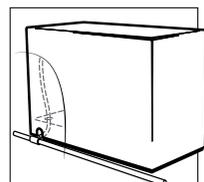
**IOP-PERFOS** Aménagements pour les passages des systèmes d'arrosage automatique et / ou d'éclairage.
